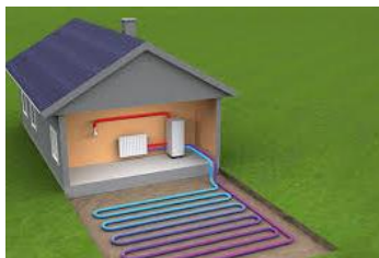
Slika 6: Delovanje TČ (horizontalni kolektor) zemlja – voda
